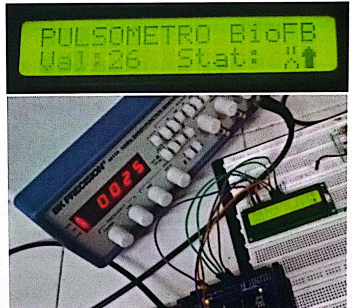
Fig. 9. Presentación visual ante una entrada de tren de pulsos con una frecuencia de 25 Hz
